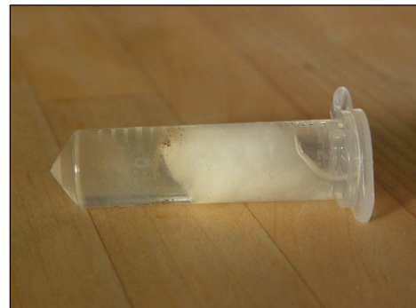
Tube avec tampon d'ouate : limite l'évaporation et évite les secousses des spécimens (cliché : E. Séchet)
